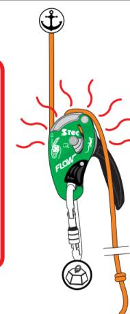
Exceto durante descidas controladas e planejadas, o FLOW deve ficar "travado". O sistema automático anti pânico não é uma maneira aceitável quando o usuário não está descendo. Para garantir que o equipamento está travado, mantenha a alavanca de controle como na figura. Não existe requerimento para uso do sistema anti pânico do modelo D05. Não deve ser usado para travamento.
