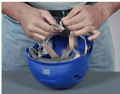
IMAGEM 2 Procure por possíveis "partes duras" das fitas dobrando-as ao longo de sua extensão
