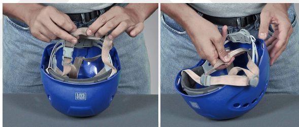
IMAGEM 3 Procure por traços de queimaduras ou ação de agentes químicos, em ambos os lados da fita e tb junto as fivelas
